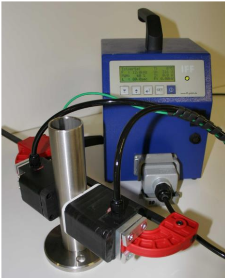
Bild 2: Induktive Aufheizvorrichtung mit Versuchsteil
